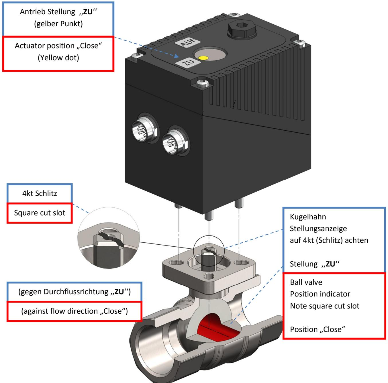
**Achtung: Bei Montage muss Antrieb und Kugelhahn gleiche Stellungs-Position haben!**
